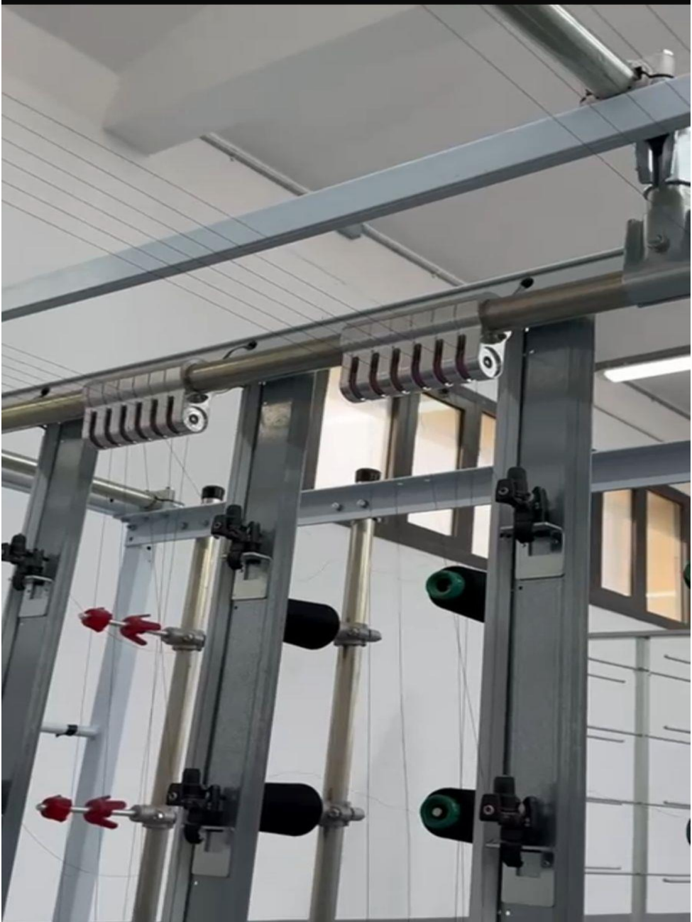
صورة رقم (17) توضح شكل الخيوط وهي تتحول إلى كونات كبيرة لبدء عملية النسيج. المصدر: تصوير الباحثة أثناء زيارة ميدانية في مجمع الملك عبدالعزيز لكسوة الكعبة المشرفة.
