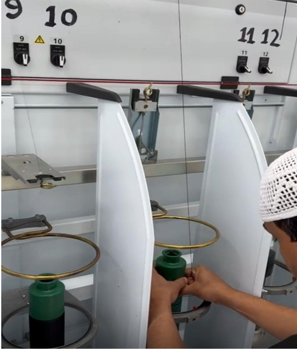
صورة رقم (14) توضح شكل القمع الأخضر والصانع يقوم بتهيئتها قبل تشغيل الآلة. المصدر: تصوير الباحثة أثناء زيارة ميدانية في مجمع الملك عبدالعزيز لكسوة الكعبة المشرفة.
