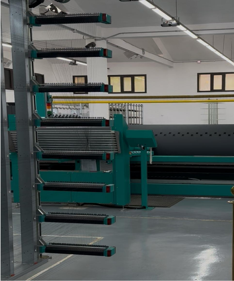
صورة رقم (9) توضح شكل حوامل ماكينة السداية الحديثة مع مرور الخيوط. المصدر: تصوير الباحثة أثناء زيارة ميدانية في مجمع الملك عبدالعزيز لكسوة الكعبة المشرفة.
