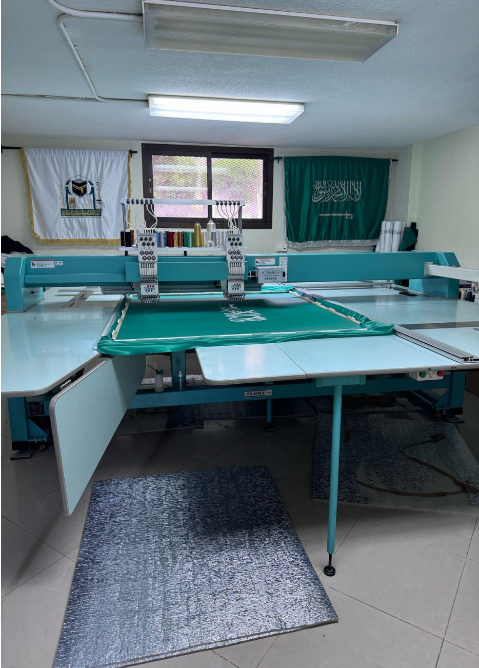
صورة رقم (23) توضح ماكينة التطريز تاجيما.
