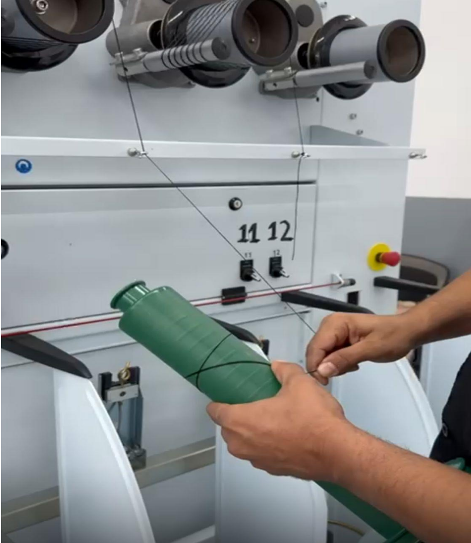
صورة رقم (13) توضح شكل القمع الأخضر والصانع يقوم بلف الخيوط قبل تشغيل الآلة. المصدر: تصوير الباحثة أثناء زيارة ميدانية في مجمع الملك عبدالعزيز لكسوة الكعبة المشرفة.
