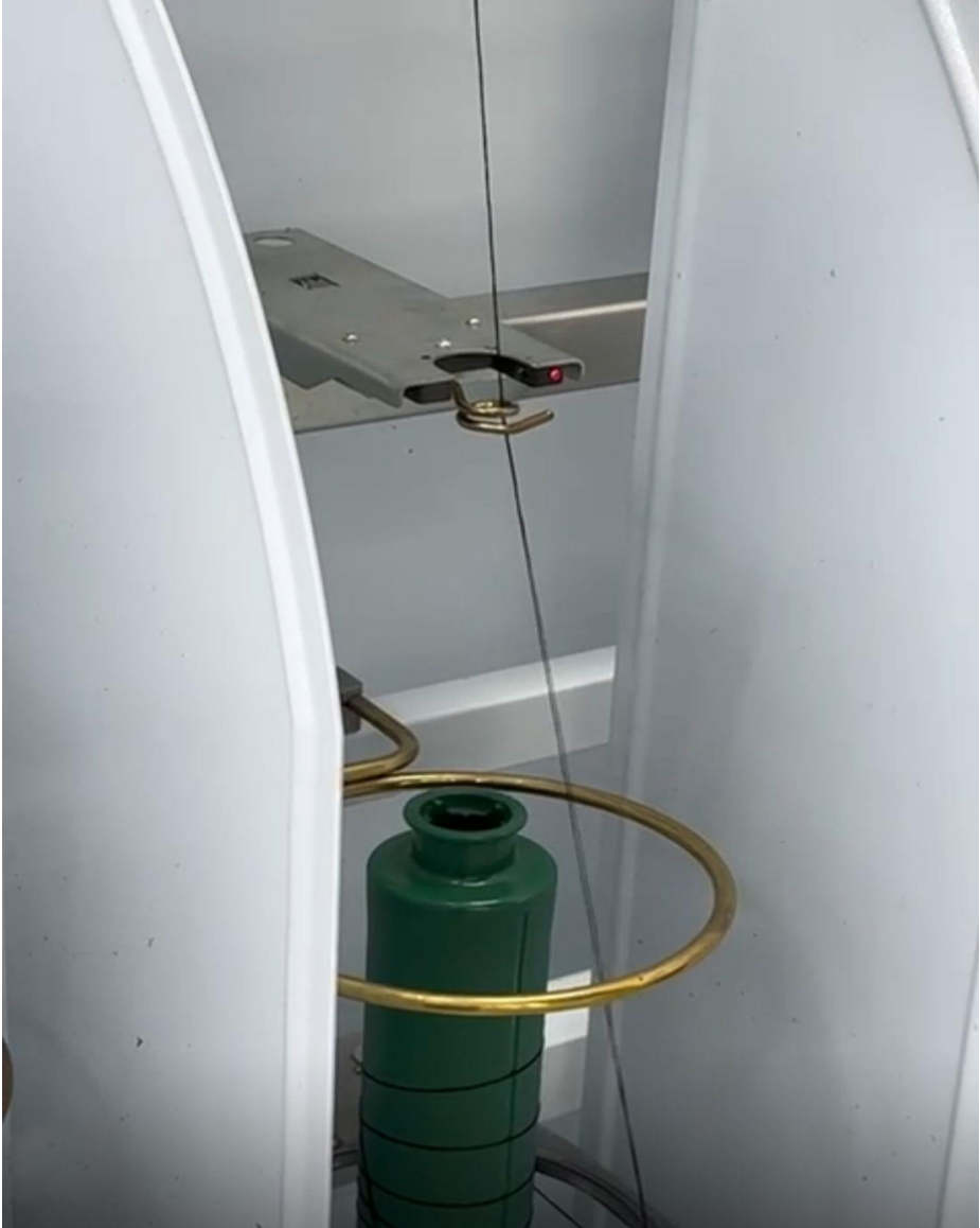
صورة رقم (15) توضح شكل القمع الأخضر وطريقة تثبيت الخيط لبدء عملية البرم والتجميع. المصدر: تصوير الباحثة أثناء زيارة ميدانية في مجمع الملك عبدالعزيز لكسوة الكعبة المشرفة.
