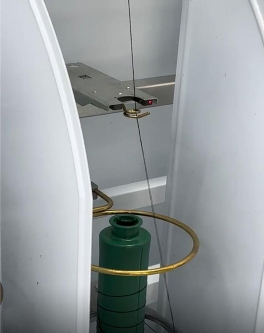
صورة رقم (15) توضح شكل القمع الأخضر وطريقة تثبيت الخيط لبدء عملية البرم والتجميع.
