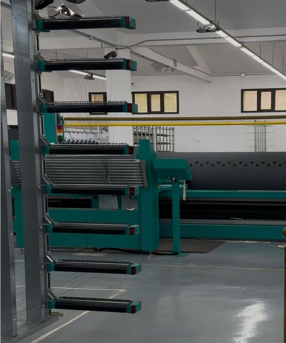
صورة رقم (9) توضح شكل حوامل ماكينة السداية الحديثة مع مرور الخيوط.
